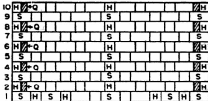
**FIG. 6.9. FLEMISH BOND (ELEVATION).**
