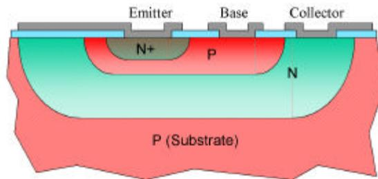
Fig. 1-9: A simple planar NPN transistor.
