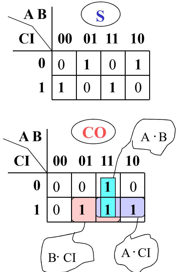
$$S = \overline{A} \cdot \overline{B} \cdot \overline{CI} + \overline{A} \cdot B \cdot \overline{CI} + A \cdot \overline{B} \cdot \overline{CI} + A \cdot B \cdot CI$$
