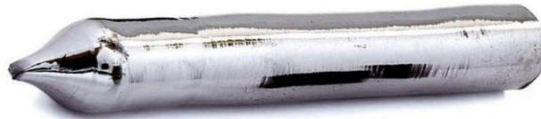
Fig: Single crystal Si ingot
